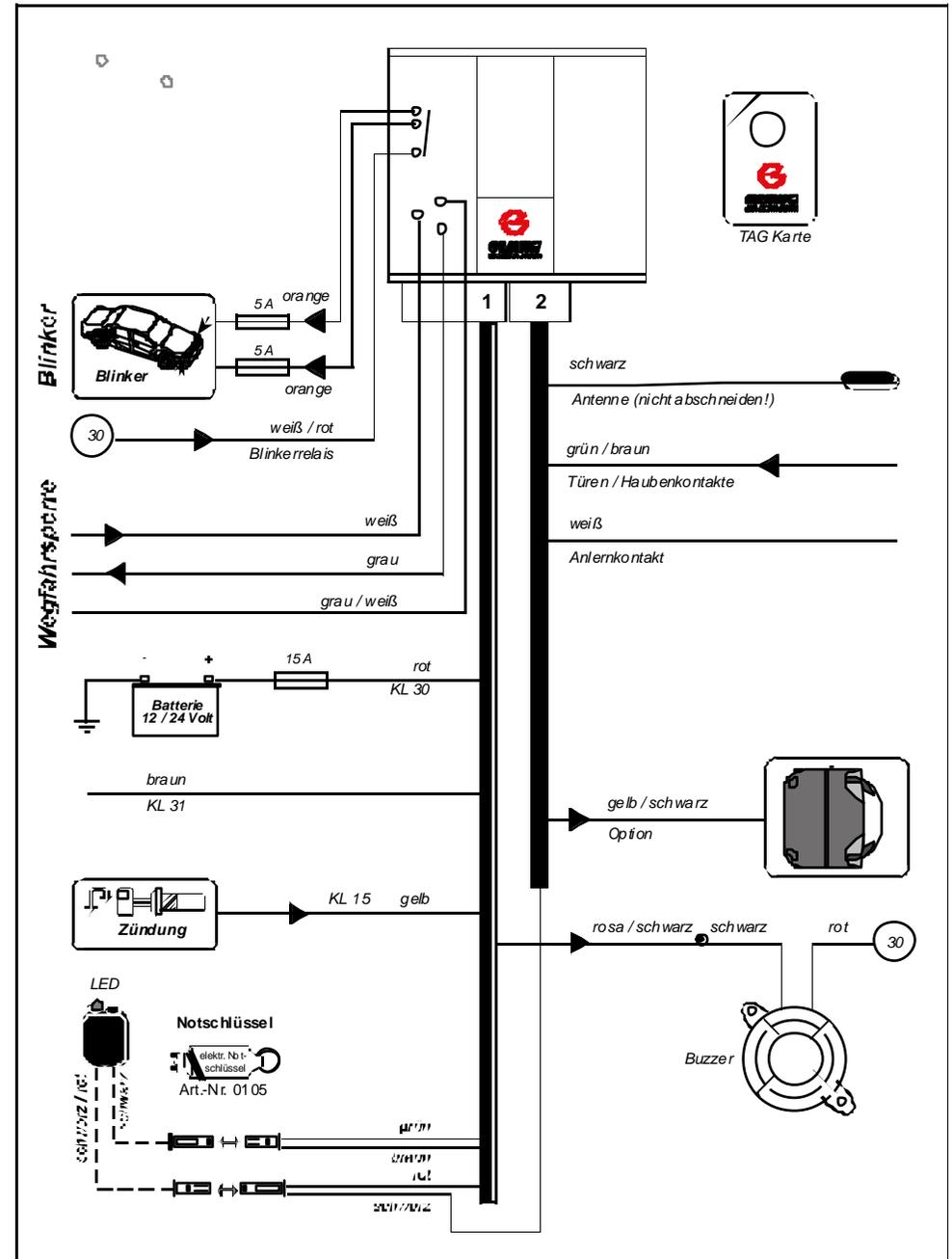
GPS / GSM Anlage mit Alarmfunktion
